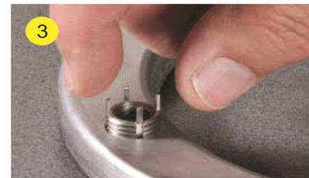
3 Loksert eindrehen bis der Absatz der Sperrkeile auf der die Werkstückoberfläche aufsetzt.
