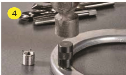
4 Einpressen der Sperrkeile, z.B. mit ein paar Hammerschlägen auf das Installationswerkzeug
