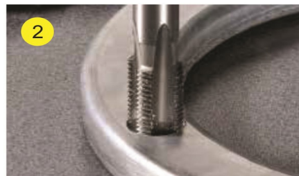
2 Gewindeschneiden mit einem Standard-Gewindebohrer
