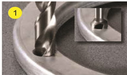
1 Bohren mit einem Standard-Bohrer und anschließend Senken
